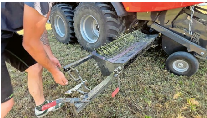
Grâce à un tiroir, la cassette de 33 couteaux est accessible aisément par l'opérateur.
