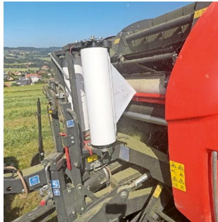
Le liage exploite deux rouleaux de film de 750 mm de polyéthylène (système Twin) pivotant horizontalement le temps du liage, ou un rouleau de filet conventionnel.
