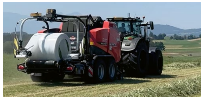
Les rouleaux du système d'enrubannage 3D enveloppent les côtés de la balle en rotation en se positionnant horizontalement, avant de retrouver leur position verticale pour enrubanner de façon conventionnelle.
