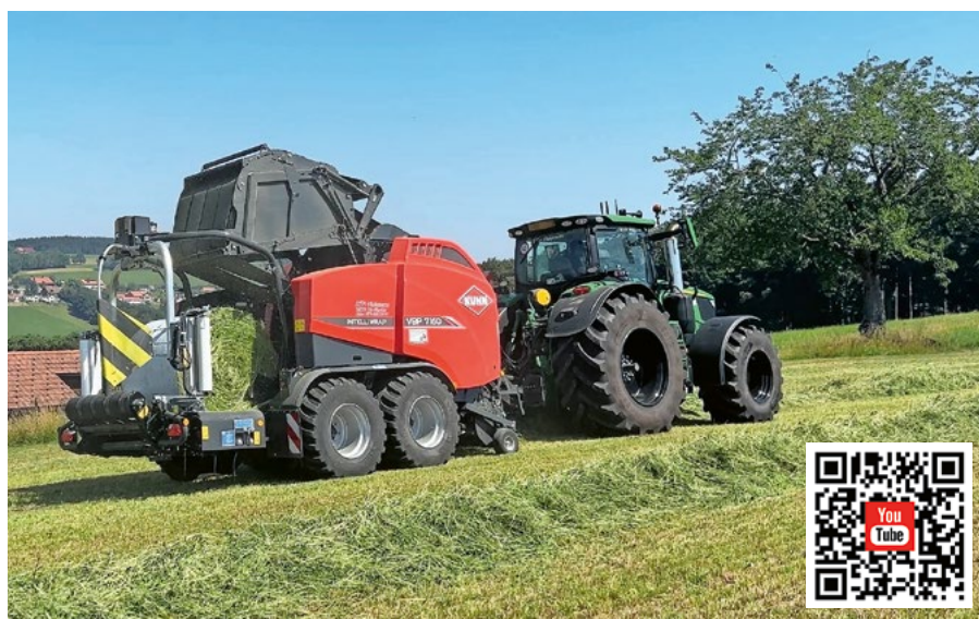
Le combiné presse-enrubanneuse Kuhn «VBP 7160» de l'ETA Flühmann «a déjà formé plus de 2000 balles le premier mois d'utilisation, avec une consommation moyenne de 0,4 litre de diesel par balle», selon l'entrepreneur. Photos: Matthieu Schubnel
