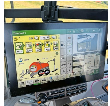
Le boîtier Isobus à l'interface soignée dispose de multiples menus de configuration pour optimiser le travail de la presse et de l'enrubanneuse.
