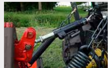
Point télescopique FRONTFLEX (uniquement avec une tête d'attelage fixe)
